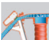
Kombi mágnesszelep (vetőmagok útja a csoroszlyához)
