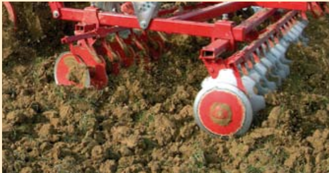
A szármaradványok egyenletes bekeverésére a Kverneland kétsorban elhelyezett könnyű tárcsát ajánl 510 mm-es tárcsalap átmérővel. A vágás szöge mindkét tárcsasoron külön-külön állítható. A munkamélységet a tárcsasorok előtt elhelyezkedő nagyméretű kerekek határozzák meg. Közép-kötött és kötött talajokon a két sor tárcsa durva, rögös felszínt hagy maga után, amely megakadályozza a hóolvadás utáni felszíni vízfolyásokat.
