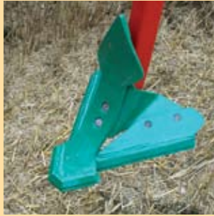
Karbid felrakású 125 mm-es duplaszív kapa, 360 mm-es szárnyas kapákkal
