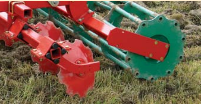
550 mm-es csöves henger jól alkalmazható könnyű talajokon. A csöves henger rugós boronával, egyengető tárcsával és egysoros tárcsával is szerelhető.
