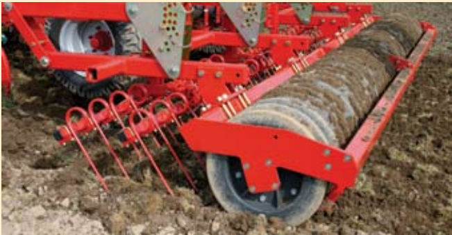
A 600 mm-es Flexline henger kiváló támasztó-mélységhatároló tulajdonságokkal rendelkezik, ami különösen könnyű talajokon előnyös. A kialakításánál fogva a Flexline henger optimális visszatömörítést és talajlezárást végez.
