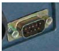
Soros port, külső forrás csatlakoztatására, pl.: GPS vevő
