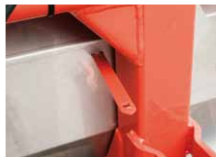
Adagoló nyílás, nyitás/zárás állapot jelző
