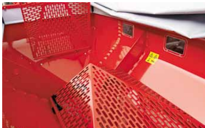
Tartályrács nyitott helyzetben, rögzítve
