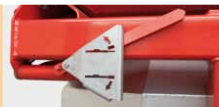
Munka- vagy szállítási helyzetjelző
