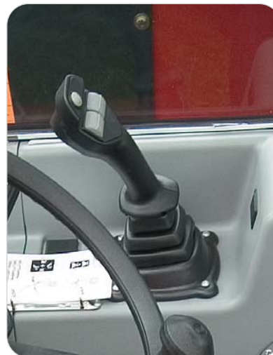
Alul: Új oldalkonzol Joystick egységgel az összes funkció állandóan arányos kezeléséhez
