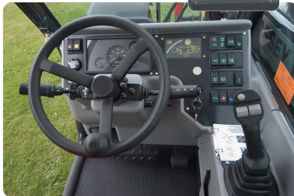
A műszerfalon elhelyezett túlterhelés kijelző minden látási viszony mellett tisztán leolvasható.
