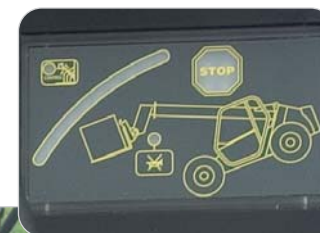
A műszerfalon elhelyezett túlterhelés kijelző minden látási viszony mellett tisztán leolvasható.
