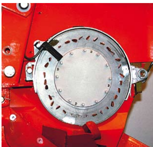
Vetőtárcsa opto-elektronikus szenzorral
