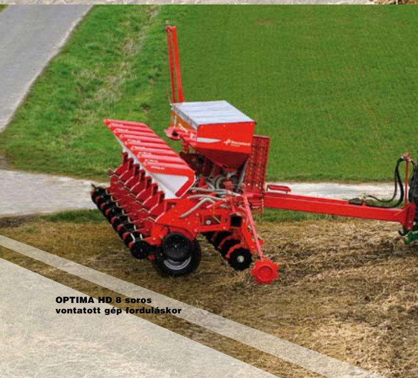
OPTIMA HD 8 soros, vontatott gerendellyel és központi műtrágyatartállyal
